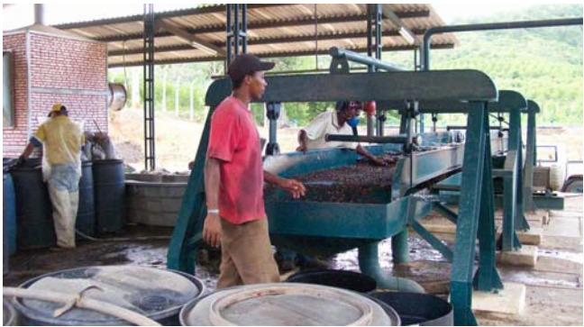
Fig. 38. Máquina para a separação de impurezas existentes em sementes de nim destinadas à moagem.
